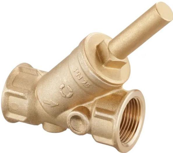
Rückflussverhinderer aus Messing für waagerechten und senkrechten Einbau. Ventilkegel federbelastet. Für Zentralheizungs- und Kühlanlagen mit geschlossenen Kreisläufen und Industrieanlagen. Nicht geeignet für den Einsatz bei pulsierendem Durchfluss oder innerhalb einer Strecke von 10 x DN hinter einer Pumpe.
