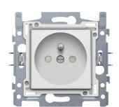
Socle pour prise de courant avec broche de terre et obturateurs de protection, profondeur d'encastrement de 28,5 mm, 16 A/250 Vac, bornes à connexion rapide.
