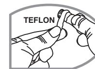
(\*\*)Teflon per tenuta idraulica
