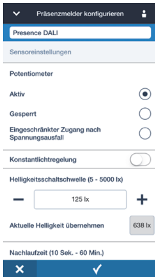
Afb. 41: Aanpassen van de gewenste helderheidswaarde voor de daglichtafhankelijke besturing
