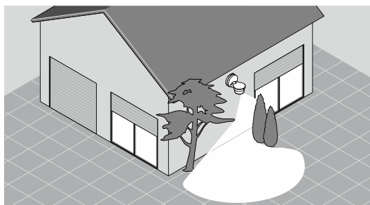
Abb. 20: Wandmontage an freistehendem Einfamilienhaus mit eingeschränktem Erfassungsbereich
