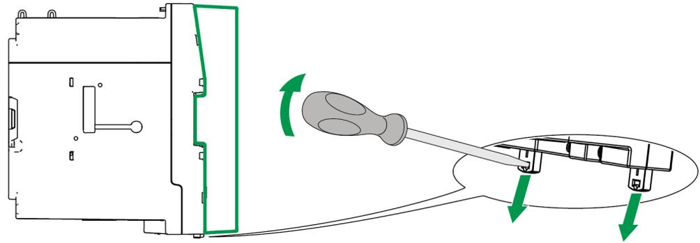
2. Tenez le compteur fermement et faites-le pivoter vers l'extérieur en tirant légèrement vers le haut pour le dégager des crochets de retenue supérieurs.
