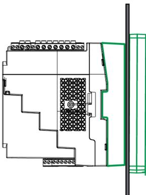
1. Tenez l'afficheur et tournez la molette de serrage à l'aide d'un tournevis à tête plate jusqu'à ce qu'elle se désengage de l'afficheur.
