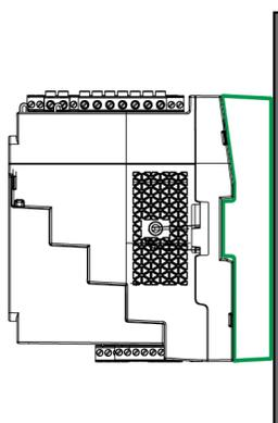
1. Utilisez un tournevis plat pour déverrouiller les brides de fixation du compteur.
