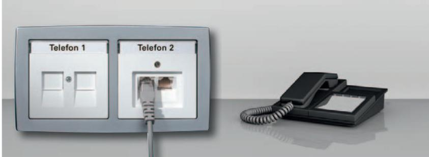
Internationale Telekommunikationsverbindungen können nur durch gleiche Anschlusstechniken realisiert werden. Weltweit einheitliche Einbaumöglichkeiten werden u. a. in der europäischen Norm EN 41001 definiert. Für diese als Modular Jack bzw. Western-Technik bezeichnete Anschlussstechnik sind auf dem Markt 4-, 6- und 8-polige Ausführungen erhältlich.
