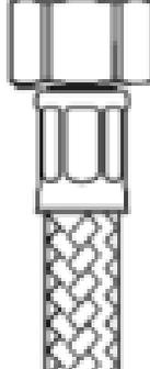
Überwurfmutter mit vormontierter Dichtung
