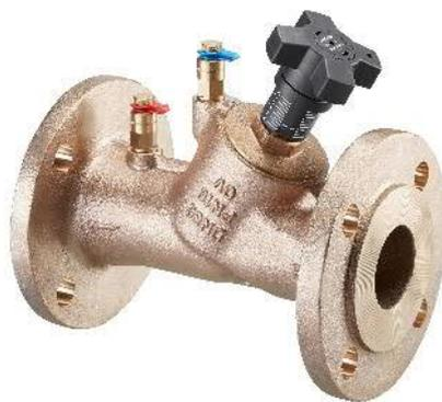
Das HydroControl VFX (Kurzbezeichnung, stellvertretend für VFC, VFN und VFR) ist ein geflanschtes Strangregulierventil für den statischen hydraulischen Abgleich von Rohrnetzen in geschlossenen Heizungs- und Kühlwasseranlagen. Es bietet eine Messfunktion über den Ventilsitz.
