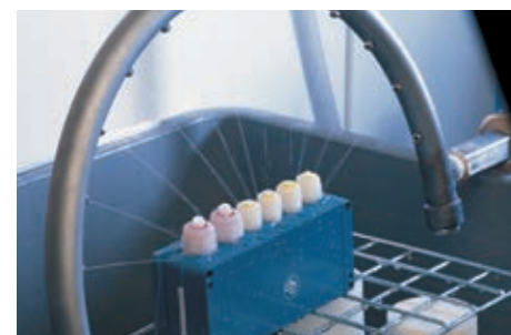
Abb. 1 – PFLITSCH-Kabelverschraubungen IP 54 Fig. 1 – PFLITSCH cable gland IP 54
