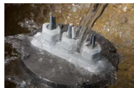
Abb. 2 – Der UNI FLANSCH bei der Wasserschutzprüfung Fig. 2 – UNI flange in a water ingress test
