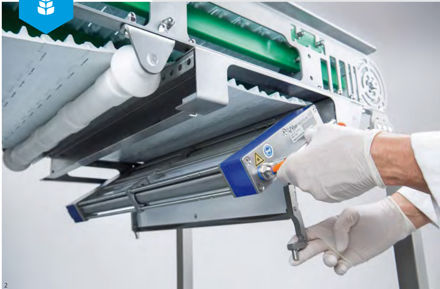
Abb. 1 – blueglobe CLEAN Plus und Blindstopfen CLEAN Plus an einem Bandentkeimer Fig. 1 – blueglobe CLEAN Plus and blind plug CLEAN Plus installed on a belt disinfectant
