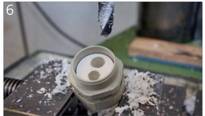
6 Zweite Bohrung in der Ansicht von unten
