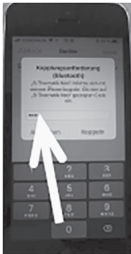
Voer 000000 in bij de koppelingsaanvraag en tik op "Koppelen".
