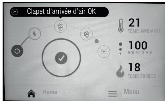
Remarque : Pour des raisons techniques, le test du clapet d'arrivée d'air ne peut être effectué que sur les moteurs de type I (servomoteur), mais pas sur les moteurs de type II (retour par ressort). Dans le cas des moteurs de type II, si un obstacle bloque la course de réglage du volet de clapet, le volet sera tordu. Il reste alors une section d'air suffisamment importante.
