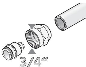
Uponor Uni-X est une gamme de raccords à compression de 3/4" Eurocône, de raccords coniques métriques et d'adaptateurs pour l'eau du robinet et les applications de chauffage/refroidissement.
