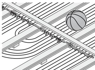
Uponor Sport est un système de chauffage et de refroidissement radiant pour les sols élastiques de surface. Ces sols constituent une synthèse de planchers oscillants en bois avec une couche élastique en PVC ou
