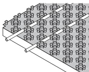
Les plaques Uponor Nubos sont spécialement conçues pour des systèmes de chauffage/refroidissement par le sol dans les bâtiments résidentiels et non résidentiels. Elles sont installées dans le sol sous la
