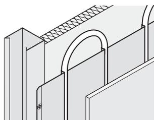
Uponor Siccus SW intègre le chauffage et le refroidissement radiants dans les murs secs en tant qu'émetteur thermique intégré. Il permet de répartir le travail selon les différents corps de métier et intègre la
