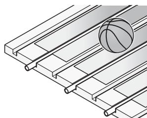
Uponor Siccus Sport est la solution pour les sols sportifs à surface élastique, conçus comme des constructions de sol en sandwich. Siccus Sport réduit les risques de blessures. Il offre un confort optimal et s'intègre dans les
