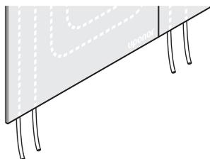
Le système Uponor Renovis pour le chauffage et le refroidissement radiants est constitué de plaques de plâtre dans lesquelles les tubes Uponor PE-Xa sont pré-intégrés dès la sortie de l'usine. Idéal pour la
