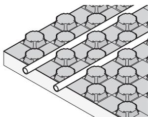
Les plaques de positionnement de tuyaux Uponor Tecto servent à installer des systèmes de chauffage/refroidissement par le sol dans les bâtiments résidentiels et non résidentiels. Elles sont
