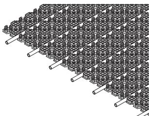
Système idéal pour la rénovation grâce à la faible hauteur des éléments (15 mm). Dalle dotée de perforations dans et entre les plots, ce qui permet un meilleur nivellement et une adhésion plus solide lors de l'installation du tube PE-Xa de 9,9mm,
