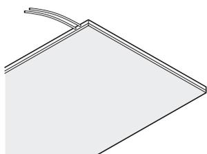
Système Uponor de chauffage et de refroidissement radiants pour installation au plafond. Se compose de tuyaux en PE-Xa de 9,9 mm préinstallés sur des panneaux de gypse standard
