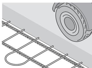
Le système de chauffage au sol industriel Uponor Magna est intégré directement dans la dalle de béton. L'armature en treillis existante peut être utilisée pour la fixation des tuyaux. Les systèmes
