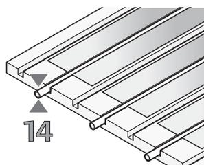
Le système Uponor Siccus 14 est un système universel de chauffage par le sol pour constructions neuves ainsi que projets de rénovation, adapté à de multiples styles de construction. Il est flexible et facile à appliquer dans une
