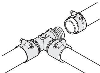
La technologie de raccords Uponor Wipex relie des canalisations en polyéthylène réticulé dans l'approvisionnement en eau potable et dans l'installation de chauffage local. Les raccords sont disponibles
