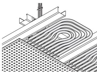
Uponor Thermanatop est un système de plafond chauffant/rafraîchissant à base aqueuse qui fonctionne essentiellement selon le principe du rayonnement et qui se caractérise par des possibilités d'application et
