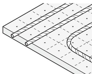
Système innovant de pose de tuyaux pour le chauffage et le refroidissement par le sol. Les tuyaux sont entourés d'un ruban de fixation à crochets ; le panneau isolant est recouvert d'un film de protection en boucle, laminé
