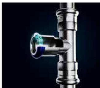
Le système de sertissage Uponor en acier inoxydable 1.4404 (AISI 316L) est le complément idéal pour la création d'installations de distribution d'eau potable. Le profil M et un film indicateur de sertissage sur chaque raccord garantissent un traitement simple et sûr.
