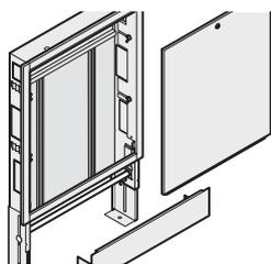
Les armoires Uponor Vario sont conçues pour être utilisées dans le cadre de l'installation d'UFH dans les bâtiments résidentiels et commerciaux. Grâce à sa flexibilité, il est possible d'intégrer tous les
