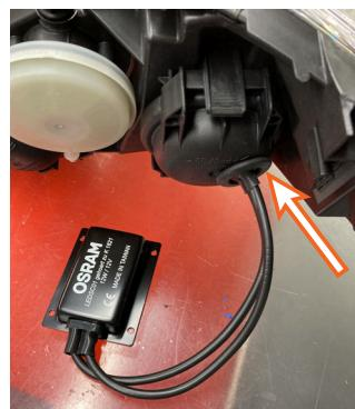
**Seal using rubber gasket.<sup>3)</sup>**
