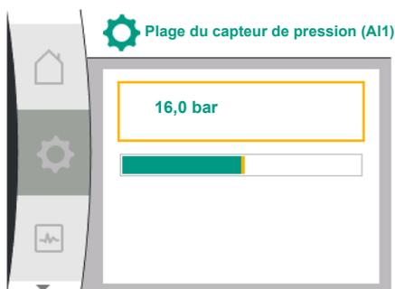
Fig. 71: Réglage Plage du capteur de pression
