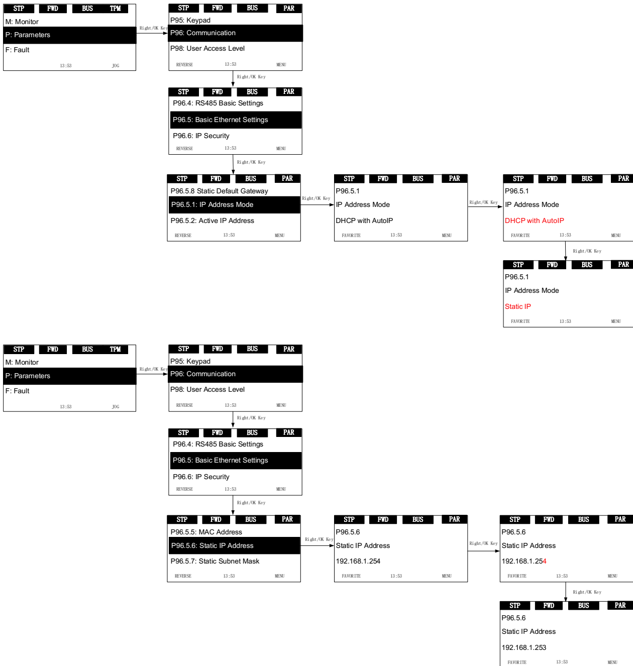
Abbildung 10. PowerXL DX1 Statischer IP-Modus
