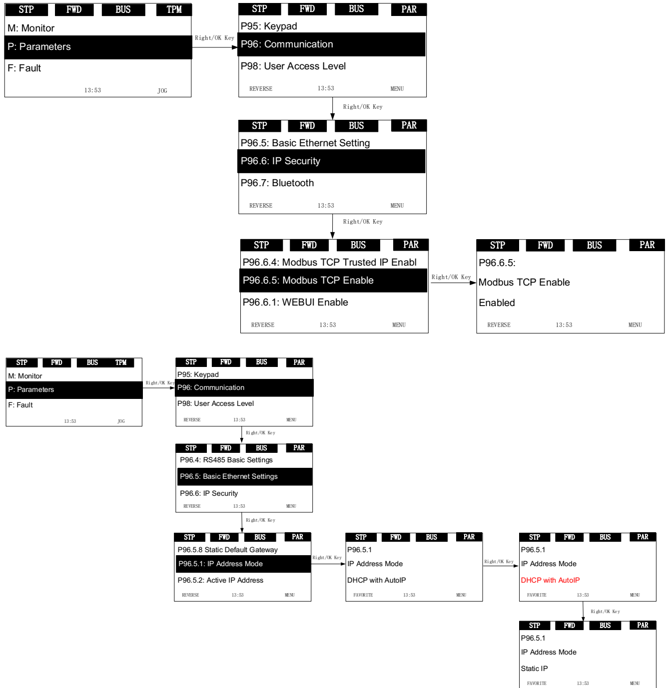
Abbildung 9. PowerXL DX1-Tastennavigation zur Aktivierung von Modbus TCP
