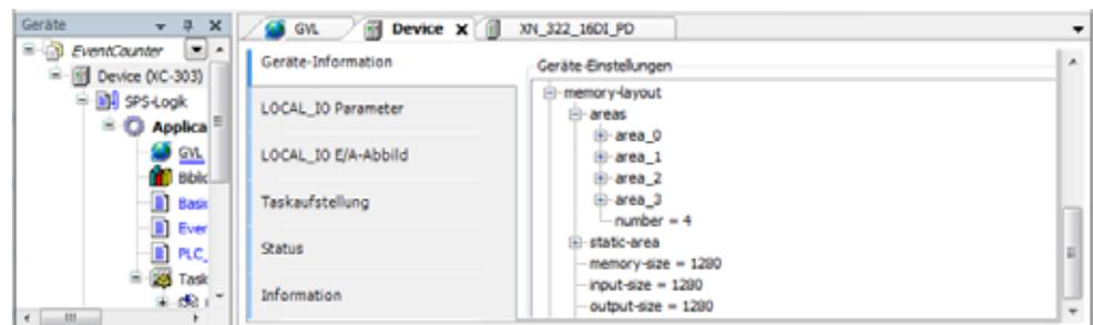
Abbildung 59: Speichersegmentgröße Device (XC-303)
