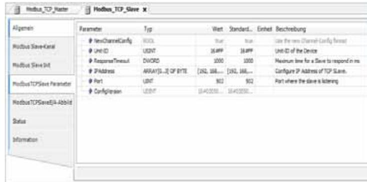
Abbildung 94: Parameter Modbus TCP Slave Parameter
