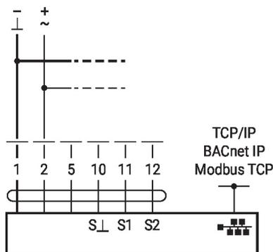
TCP/IP (Cloud) / BACnet IP / Modbus TCP mit analogem Sollwert (Hybridbetrieb)
