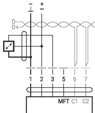
Möglicher Eingangsspannungsbereich: 0...10 V
