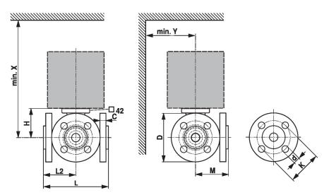
X/Y: Mindestabstand bezogen auf die Ventilmitte. Die Abmessungen des Antriebes sind dem jeweiligen Antriebsdatenblatt zu entnehmen.
