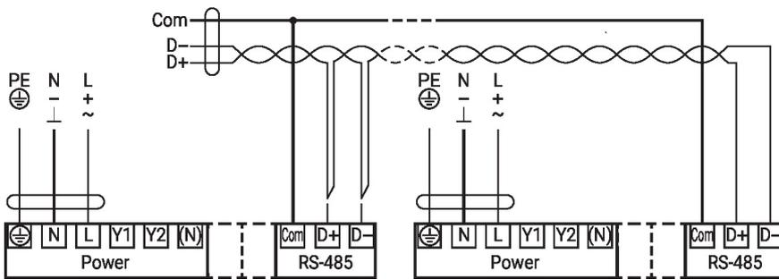
Anschluss BACnet MS/TP / Modbus RTU mit analogem Sollwert (Hybridbetrieb)
