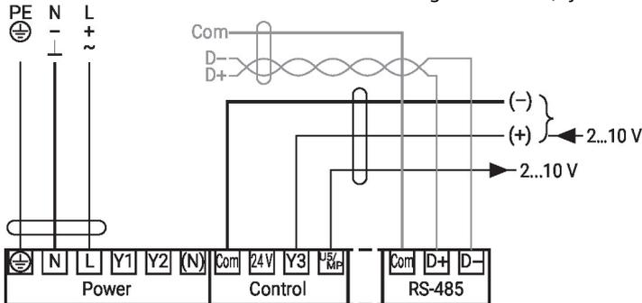
Anschluss passive Sensoren (BACnet MS/TP / Modbus RTU)
