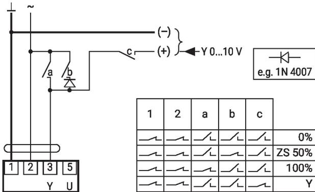
Zwangssteuerung mit AC 24 V mit Drehschalter
