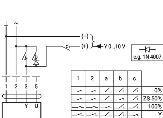
Zwangssteuerung mit AC 24 V mit Drehschalter
