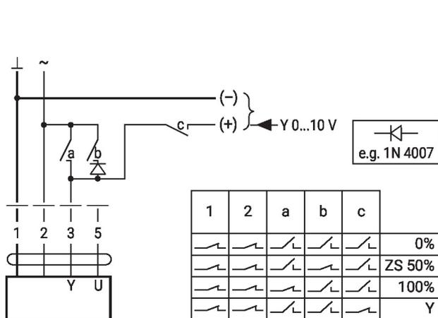
Zwangssteuerung mit AC 24 V mit Drehschalter
