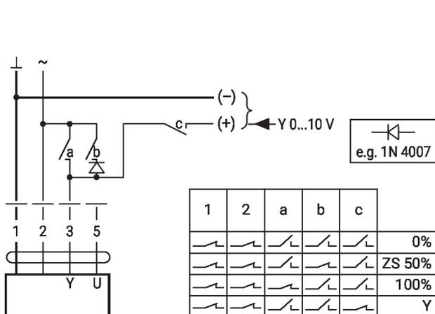
Zwangssteuerung mit AC 24 V mit Drehschalter
