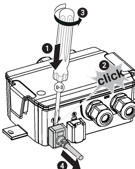
**Antrieb anschliessen** Um den IP-Schutz und die elektrische Verbindung zu gewährleisten, muss der VST-Stecker vollständig in die Anschlussbuchse (I)(M) eingeschoben werden. Für den Steckvorgang ist ein gewisser Krafteinsatz erforderlich.
