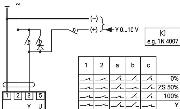
Zwangssteuerung mit AC 24 V mit Drehschalter
