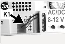
**Spannungsversorgung mit =/8-12V (0,5A)**
