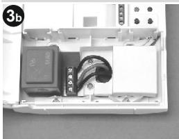
**Spannungsversorgung mit ~230V (50Hz)**
