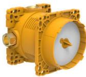
Corps encastrable, pour mitigeurs de bain et douche, raccordement 1/2", avec arrêt des eaux, inversion entrées/sorties possible
