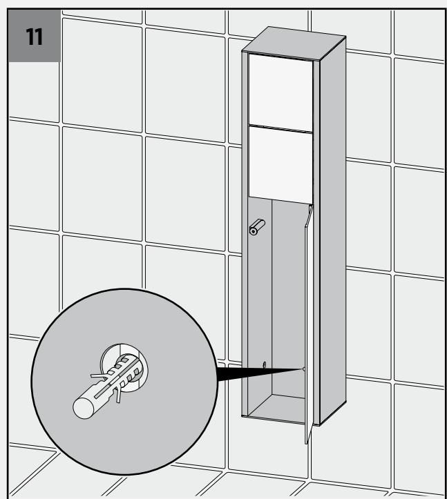
**montage** aufbauversion · installing mounted version · montage version montable · montage opbouwuitvoering
