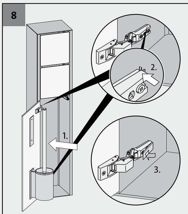
**einstellungen scharniere** · adjusting hinges · réglage des charnières · instellen van de scharnieren
