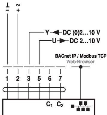
MP-Bus via 2-Draht-Anschluss, lokale Spannungsversorgung
