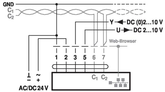
BACnet IP / Modbus TCP mit analogem Sollwert (Hybridbetrieb)
