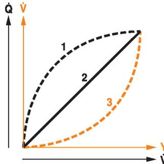
**Leistungsregelung** Alternativ kann das Stellsignal DDC der benötigten abgegebenen Leistung am Wärmetauscher zugeordnet werden.
