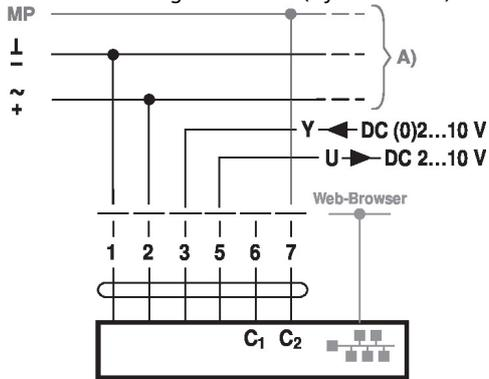
BACnet MS/TP / Modbus RTU mit analogem Sollwert (Hybridbetrieb)
