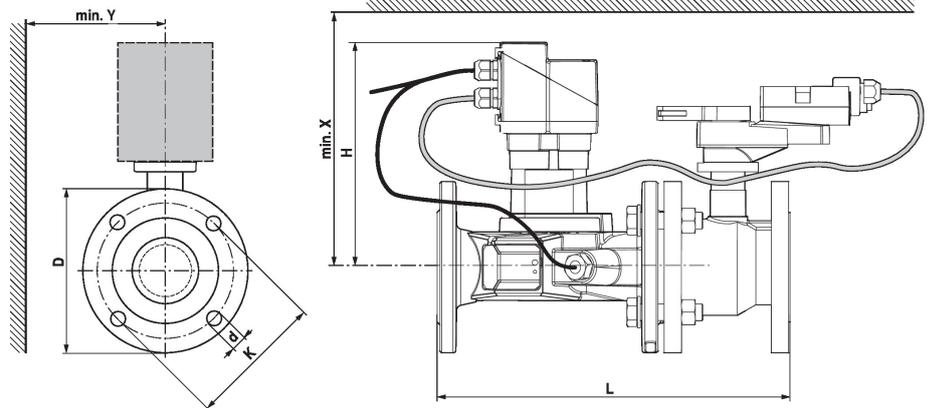
Bei  $Y < 180$  mm muss die Verlängerung der Handkurbel gegebenenfalls demontiert werden.
