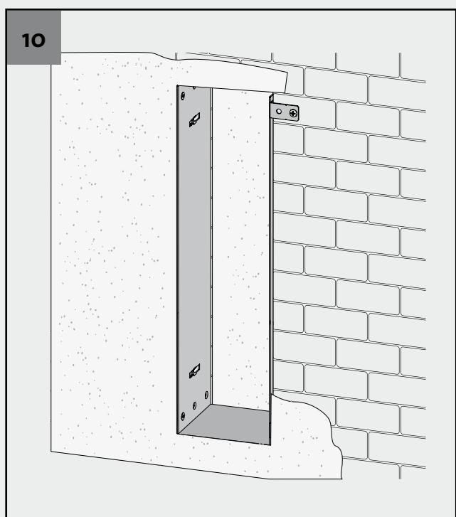
**montage** - einbaurahmen in mauerwerk · installation frame in masonry ·
