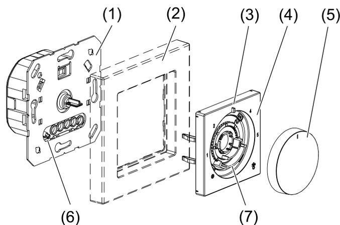
Bild 1: Geräteaufbau
