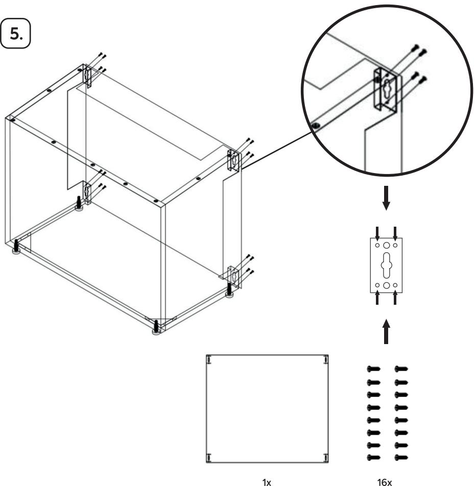
NL | Schroef de bovenplaat op de omkasting met de 9 schroeven.
