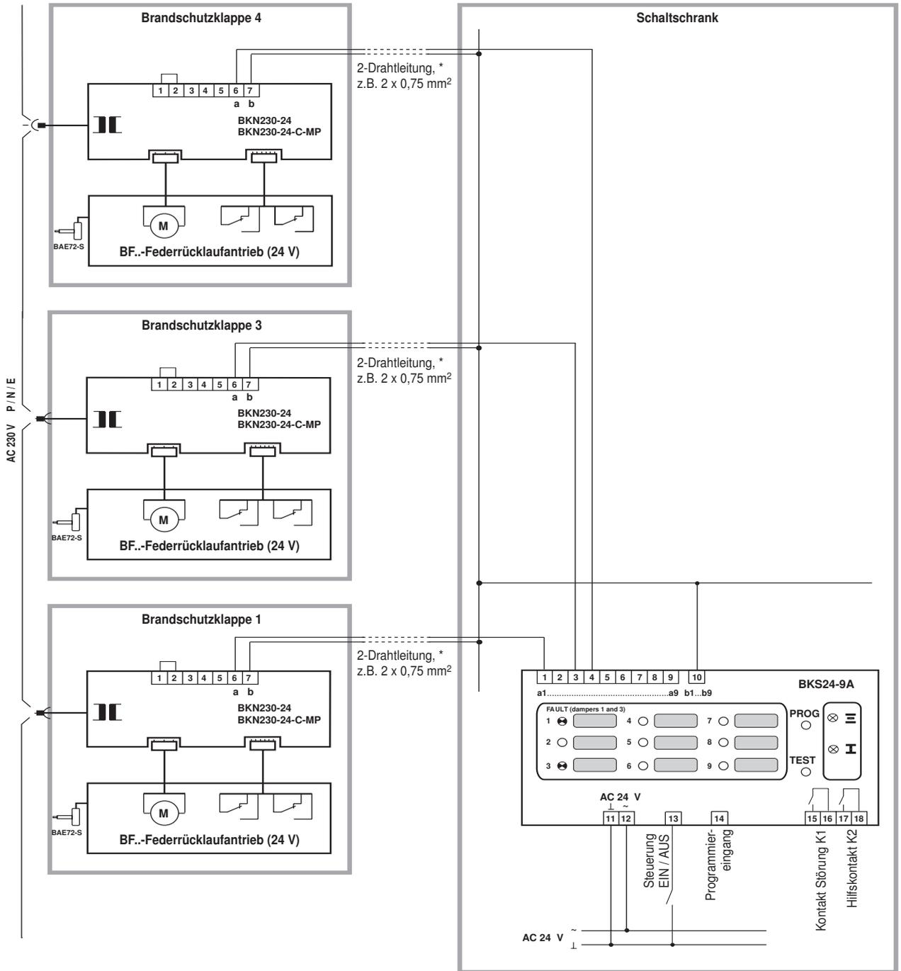
\* Leitungslängen 2-Drahtleitung a/b max. 600 m (0,75 m<sup>2</sup>)
