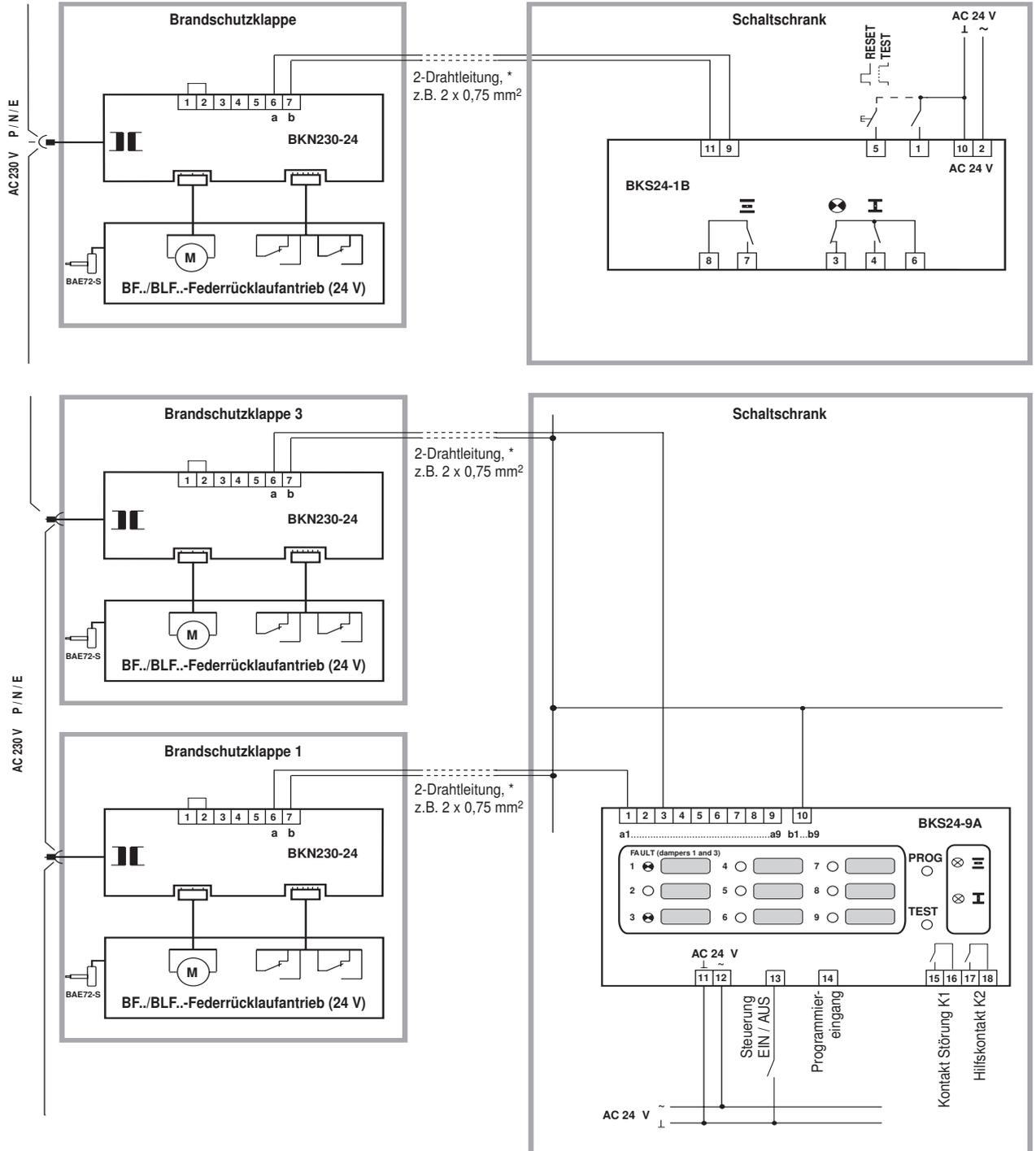
\* Leitungslängen 2-Drahtleitung a/b max. 600 m (0,75 m<sup>2</sup>)
