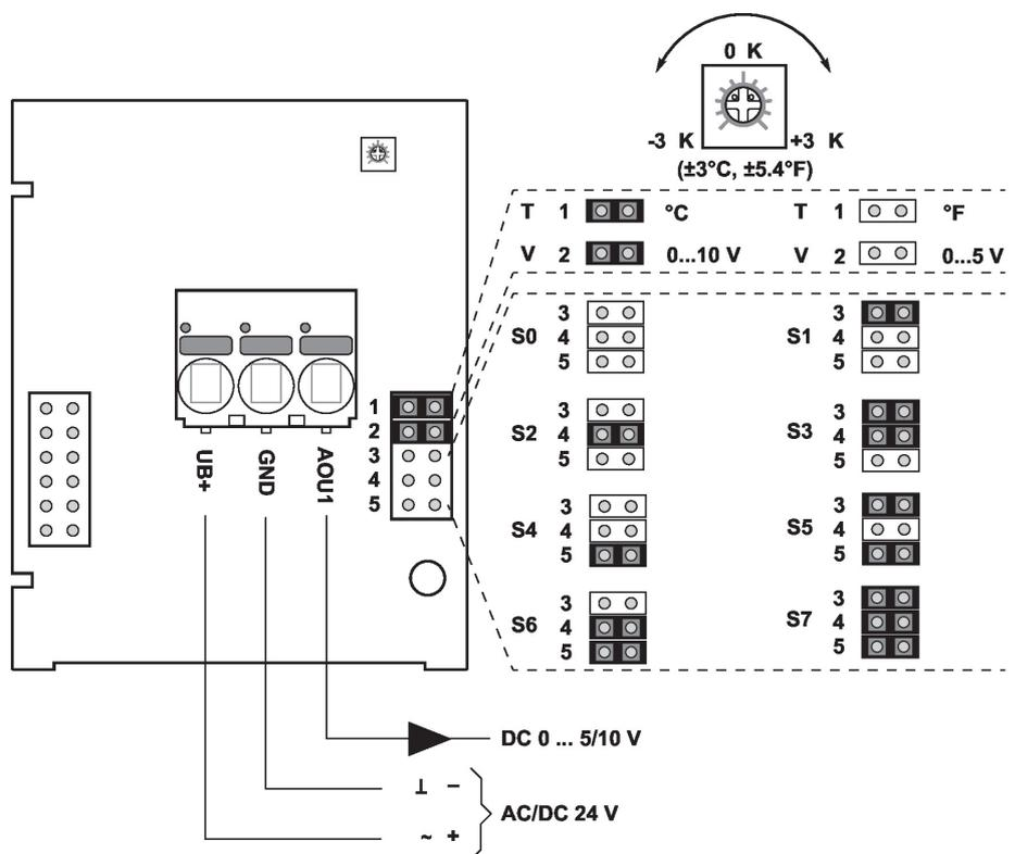
Die Einstellung der Messbereiche erfolgt durch Änderung der Bonding-Jumper. Der Ausgangswert im neuen Messbereich ist nach 2 Sekunden verfügbar.
