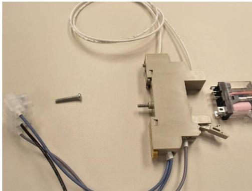
Bild 2: Relais demontieren von Halter
