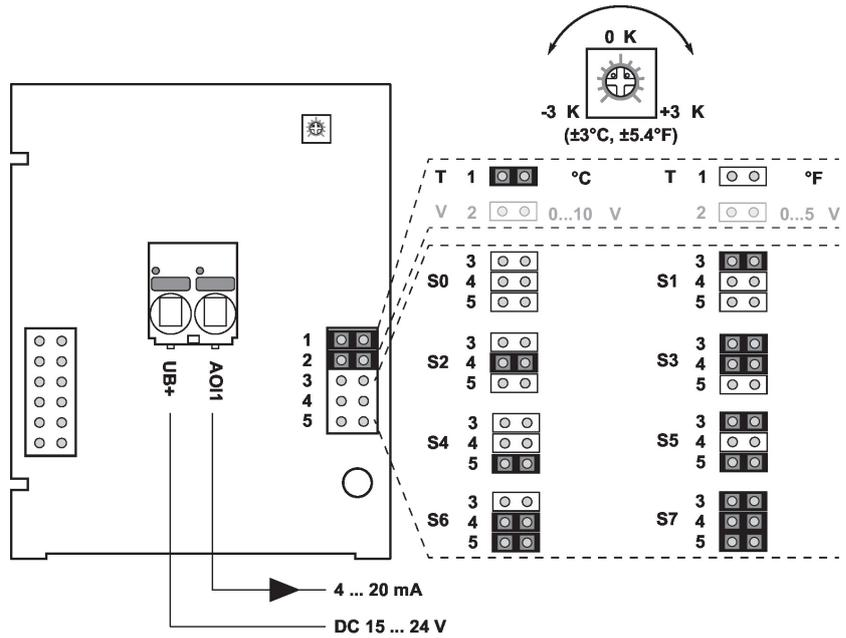
Die Einstellung der Messbereiche erfolgt durch Änderung der Bonding-Jumper. Der Ausgangswert im neuen Messbereich ist nach 2 Sekunden verfügbar.
