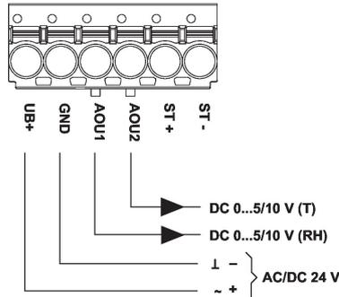
Anschlussstecker ST+ / ST- sind nur für Sensortypen zu verwenden, die zusätzlich über ein passives Widerstands-Sensorelement für Temperaturmessungen verfügen. Die Einstellung der Messbereiche erfolgt durch Änderung der Bonding-Jumper. Der Ausgangswert im neuen Messbereich ist nach 2 Sekunden verfügbar.
