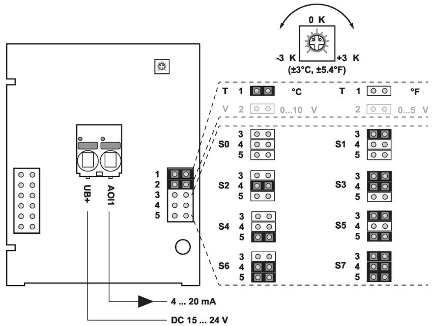
Die Einstellung der Messbereiche erfolgt durch Änderung der Bonding-Jumper.
