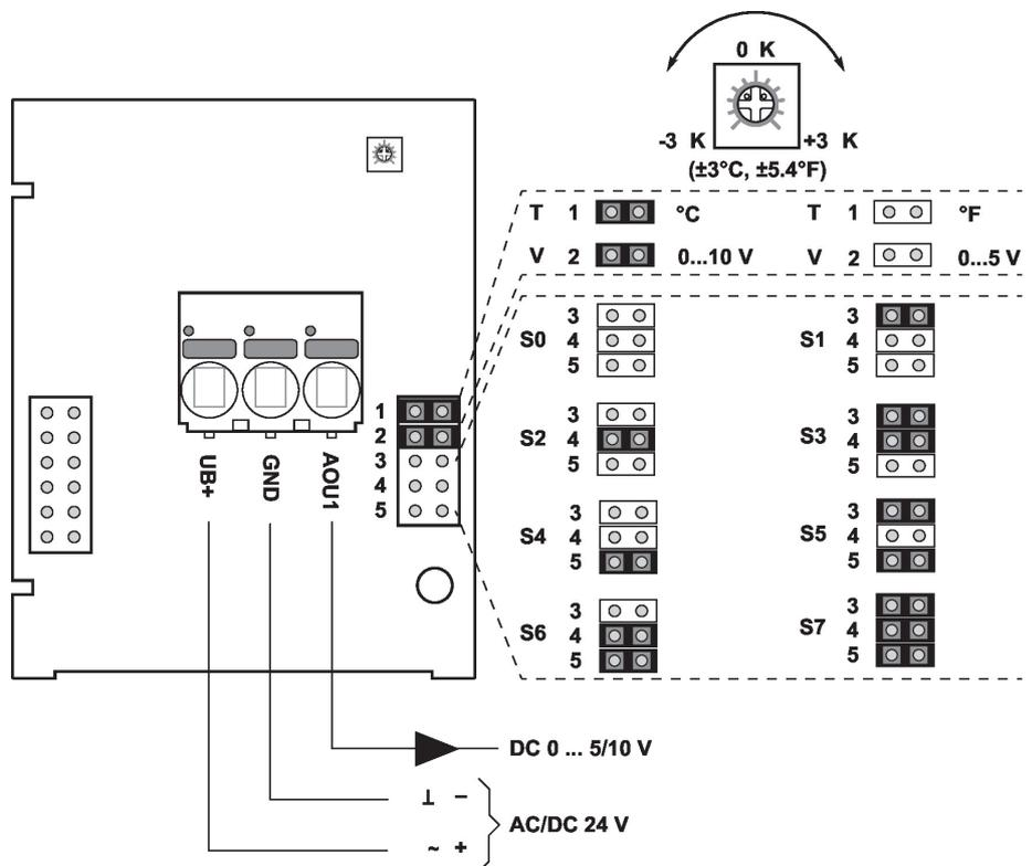
Die Einstellung der Messbereiche erfolgt durch Änderung der Bonding-Jumper. Der Ausgangswert im neuen Messbereich ist nach 2 Sekunden verfügbar.
