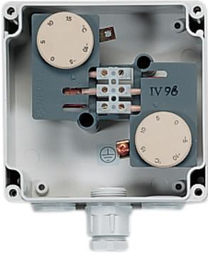
Bimetall-Doppelthermostat zur einfachen Regelung von Dachrinnenbeheizungen. In Abhängigkeit der Eisbildung sind 2 Temperaturpunkte einstellbar. Nur für Anlagen kleiner 20 m, bei größeren Anlagen empfehlen wir eine feuchte- und temperaturabhängige Steuerung. Plusbereich: 0 bis 15 °C, Minusbereich: -15 bis 0 °C, Schaltstrom: 16 A, Montage: Aufputz, Schutzart: IP 65, CE konform.
