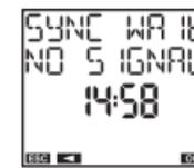
Das DY GPS Modul empfängt kein gutes Signal für eine korrekte Synchronisierung. Wenn dieser Zustand länger als ein paar Stunden anhält, empfehlen wir, das DY GPS-Modul anderswo zu platzieren (außerhalb des Gebäudes).
