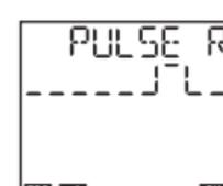
Bei Sonnenaufgang für eine einstellbare kurze Dauer (Impuls, max. 59 Sekunden) einschalten.
