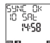
Das DY GPS Modul empfängt ein gutes Signal für eine korrekte Synchronisierung. Es zeigt die Anzahl der angeschlossenen Satelliten (in diesem Beispiel 10) an.
