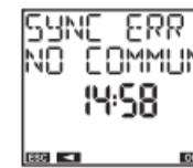
Das DY GPS Modul ist nicht richtig an der DY365 angeschlossen. Überprüfen Sie die Anschlusspläne in diesem Handbuch.
