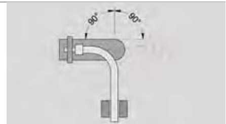
Flexibilitätsprüfung | Wechselbiegeprüfung nach Flexa Norm 1036 Flexibility test | Alternate bending test acc. to Flexa norm 1036
