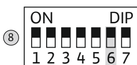
Fig. 17: Interrupteur DIP 1 : « Kick » de la pompe
