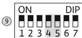
Fig. 18: Interrupteur DIP 2 : Affichage du délai de maintenance
