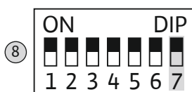
Fig. 16: Interrupteur DIP 1 : alarme sonore intégrée
