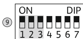
Fig. 19: Interrupteur DIP 2 : surveillance des paramètres de fonctionnement
