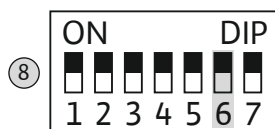
Fig. 17: Conmutador DIP 1: arranque periódico
