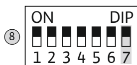
Fig. 16: Conmutador DIP 1: zumbador interno
