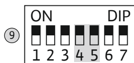
Fig. 18: Conmutador DIP 2: indicador de intervalos de servicio
