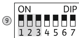
Fig. 19: Conmutador DIP 2: vigilancia de los parámetros de funcionamiento
