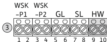
Fig. 13: Regleta de bornes de sensores: Alarma por rebose
