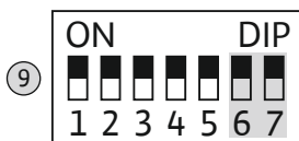
Fig. 10: Conmutador DIP 2: active las bombas
