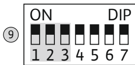
Fig. 19: DIP stikalo 2: Nadzor obratovalnih parametrov
