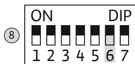
Fig. 17: DIP stikalo 1: Kratkotrajen zagon črpalke
