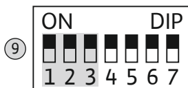
Fig. 19: Διακόπτης DIP 2: Επιτήρηση των παραμέτρων λειτουργίας
