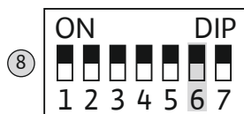
Fig. 17: Διακόπτης DIP 1: Δοκιμαστική λειτουργία αντλιών
