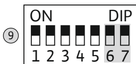
Fig. 10: DIP-kytkin 2: Pumppujen aktivointi
