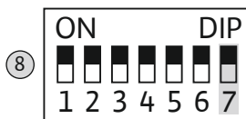
Fig. 16: DIP-kytkin 1: sisäinen summeri
